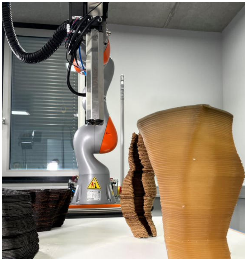
Abbildung 3: 3D-Druck-Roboter mit Druckergebnissen aus organischen Material
